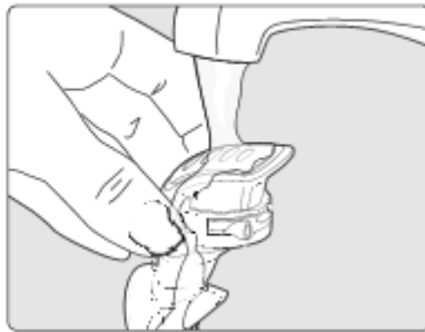
Manipulace s ventilem (otevírání, zavírání) během čištění
